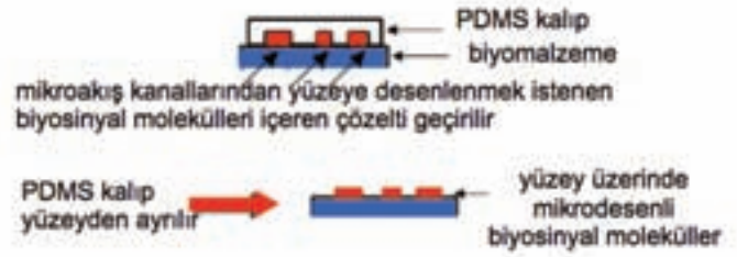
Şekil 9. Mikroakış kanalları ile mikrodeseleme tekniğinin şematik görünümü.
